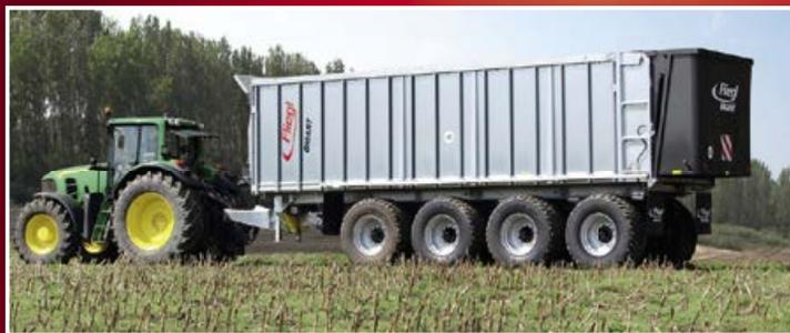
Прицепы – вагоны с выдвигающейся стенкой: грузоподъемность от 14 т до 40 т, объем от 20 куб.м до 60 куб.м, до 60% увеличения загрузки за счет оптимального прессования
