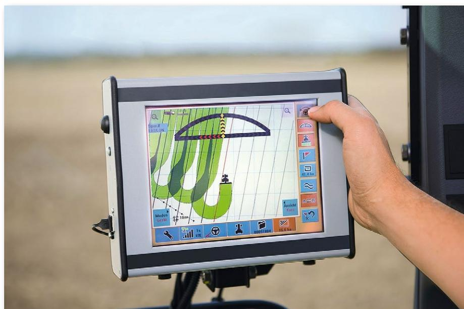
движения последних обработок и ряд других параметров: площадь поля, число и номера проходов. Отличные оценки за качество реализации таких возможностей получила модель EZ Guide 250. В противоположность ей у оборудования Centerline 220 при отключении питания исчезают и не сохраняются все показатели, но данный недочет был исправлен в следующих моделях.
