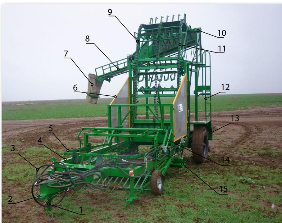
**Рис. 1.** Основные узлы прицепного устройства для механизированной уборки тыквы с сохранением исходных свойств сырья: 1 — стойка опорная; 2 — прицепное устройство; 3 — гидросистема; 4 — рама; 5 — устройство подборочное; 6 — ограждение; 7 — рукав выгрузной насадкой; 8 — лоток выгрузной; 9 — штырьевое ограждение лотка выгрузного; 10 и 15 — гидромоторы; 11 — узел транспортировочный; 12 — лестница; 13 — колесная пара; 14 — рычаг.
